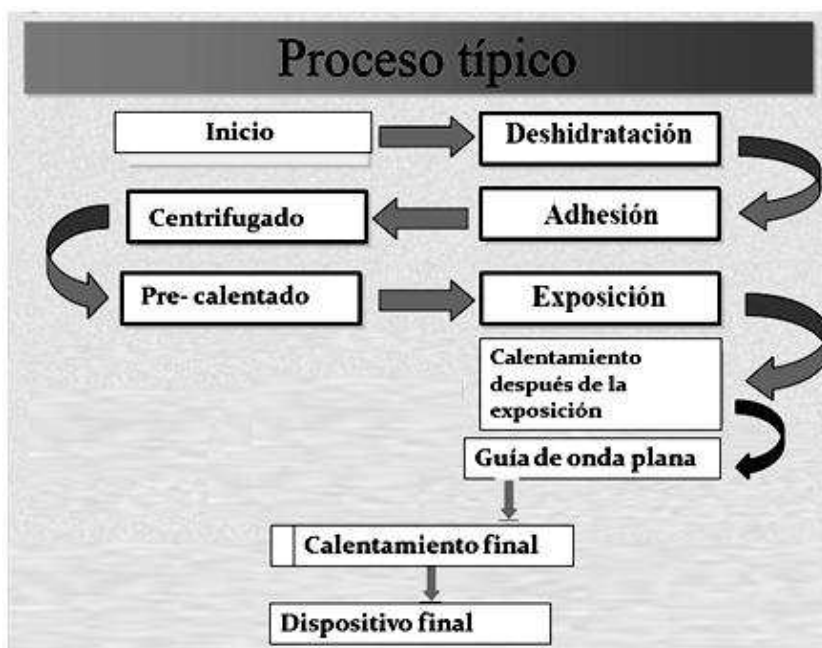
Figura 23. Proceso necesario para la realización de las guías de onda planas de polímeros ópticos.
