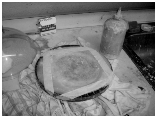
Figura 26. Material necesario para el pulido de los substratos: disco de pelte y sustancia con macropartículas para el pulido.
