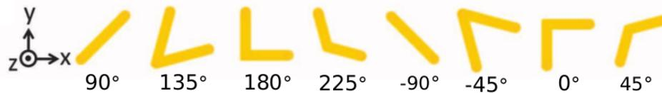
Figura 17: Gradiente de fase compuesto por ocho nanoantenas tipo “V” con amplitud de espaciamiento igual y diferencia de fase  $\Delta\Phi = \frac{\pi}{4}$  entre antenas vecinas. Tomada de la referencia Yu *et al.* (2011).
