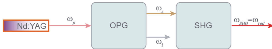
Figura 13. Generación de luz roja mediante OPG+SHG
