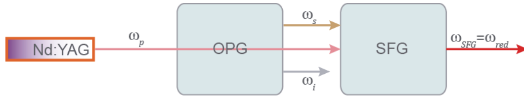
Figura 15. Generación de luz roja mediante OPS+SFG
