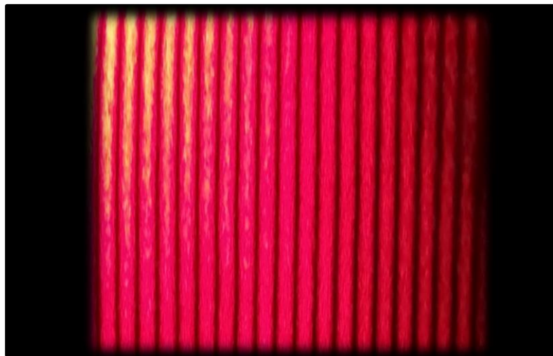
Figura 21. Franjas obtenidas por reflexión en la cubeta óptica (ambas caras) al incidir luz monocromática a una longitud de onda de 632.8 \text{ nm} .
