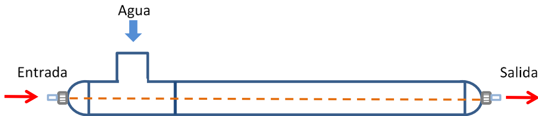
Figura 35. Fibra de núcleo líquido aislada contra agentes externos (temperatura, ruidos y vibraciones) dentro de un tubo de CPVC.
