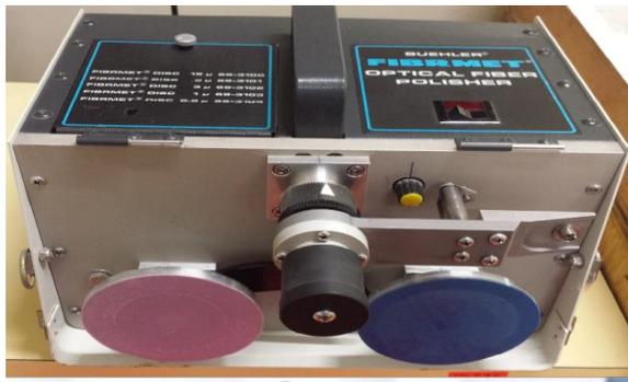
**Figura 18. Pulidora automática para férulas.**
