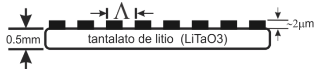
Figura 12. Cristal tantalato de litio con escalones de fotorresina.
