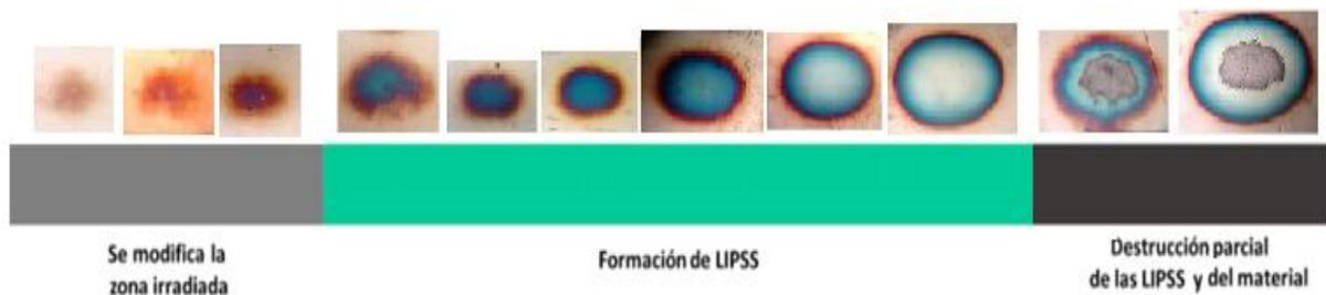
Figura 18. Modificación en la película delgada de titanio debido a irradiación de pulsos láser de nanosegundos.
