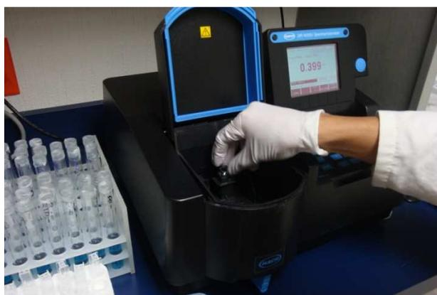
**Figura 5.** Medición de las muestras en el espectrofotómetro para determinar la concentración de amonio.
