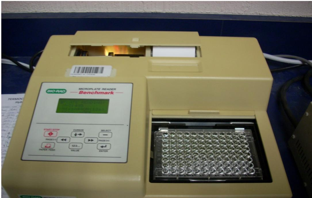
**Figura 6. Lector de placas Benchmark Bio-R. Se observa placa con reacción en proceso para la determinación de glucosa.**
