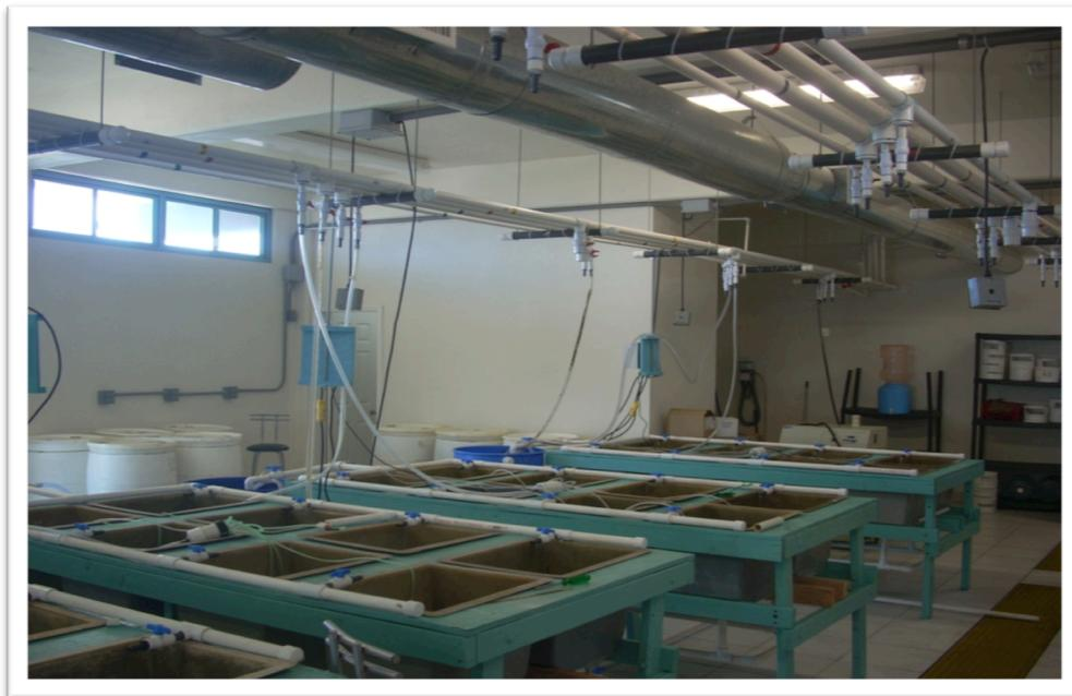
**Figura 3. Mesas de aclimatación en Laboratorio húmedo, conectadas a sistema de oxigenación y de recambio continuo de agua de mar en un sistema cerrado.**
