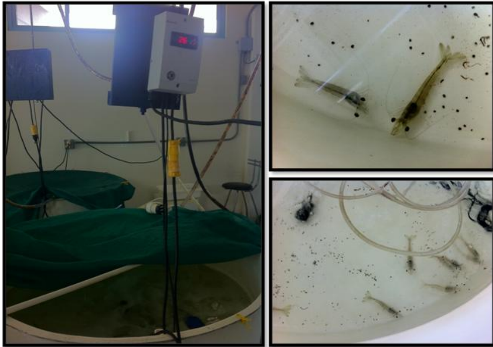
Figura 3. Estanques de 500L de capacidad para la aclimatación a diferentes temperaturas de organismos experimentales.
