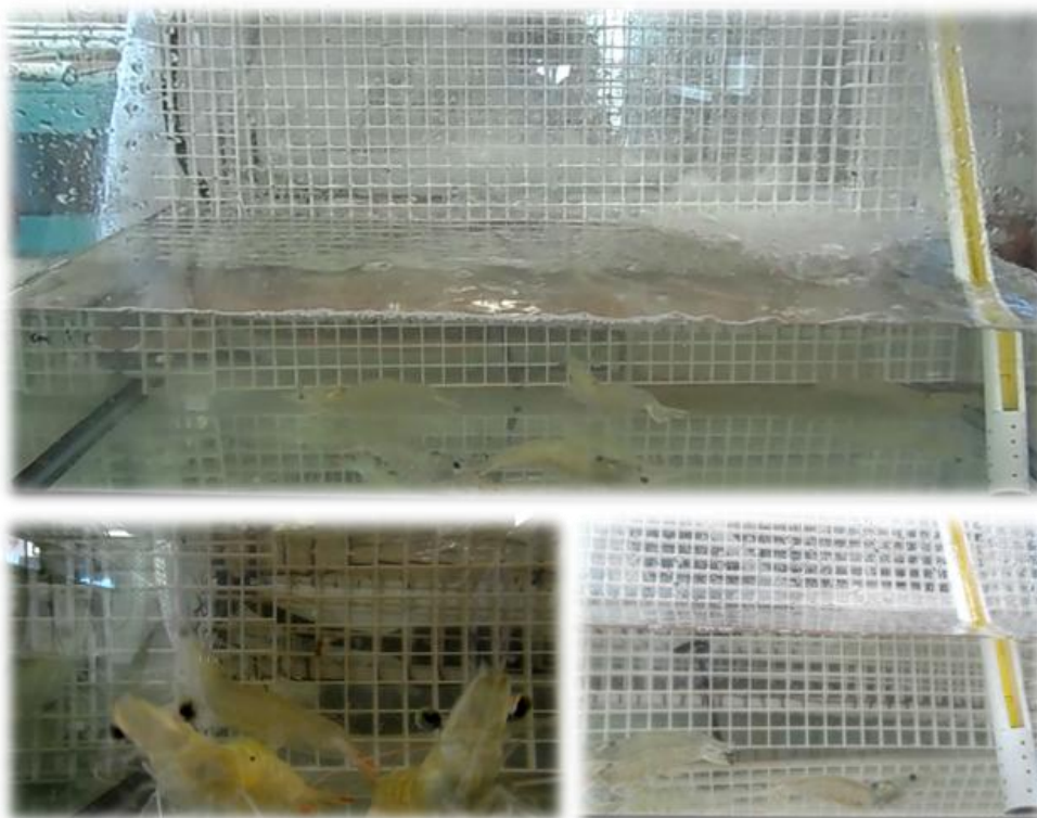
Figura 5. Experimento de TCM max y supervivencia realizados en acuarios de 60L.
