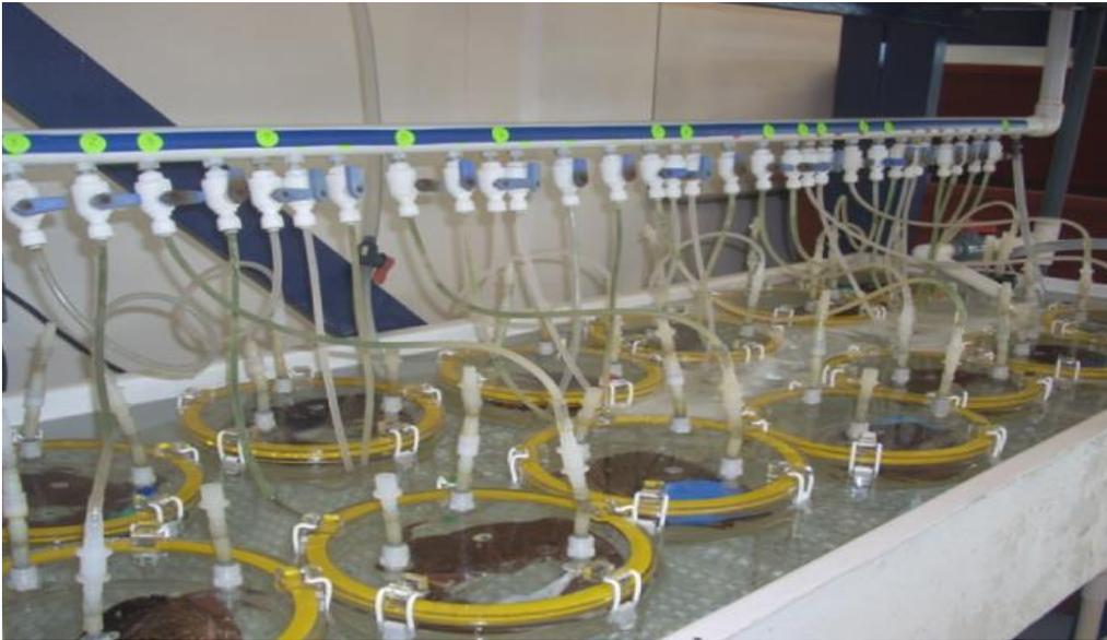
**Figura 10. Sistema respirometrico semi abierto para medición del consumo de oxígeno.**
