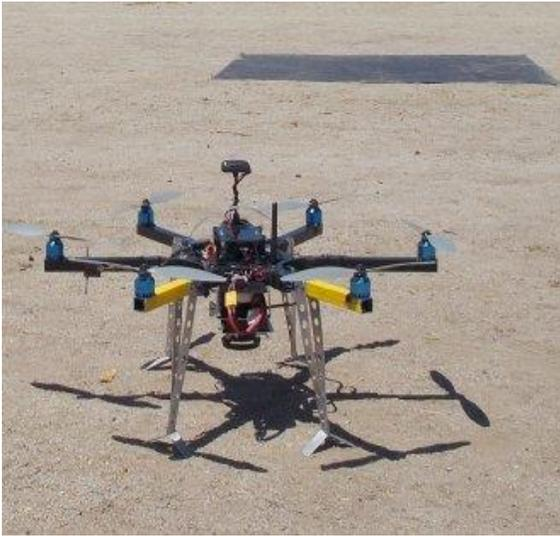
Figura 4. Hexacóptero utilizado para el levantamiento fotogramétrico
