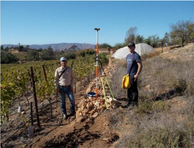
**Figura 5. Adquisición de puntos de control en el terreno**
