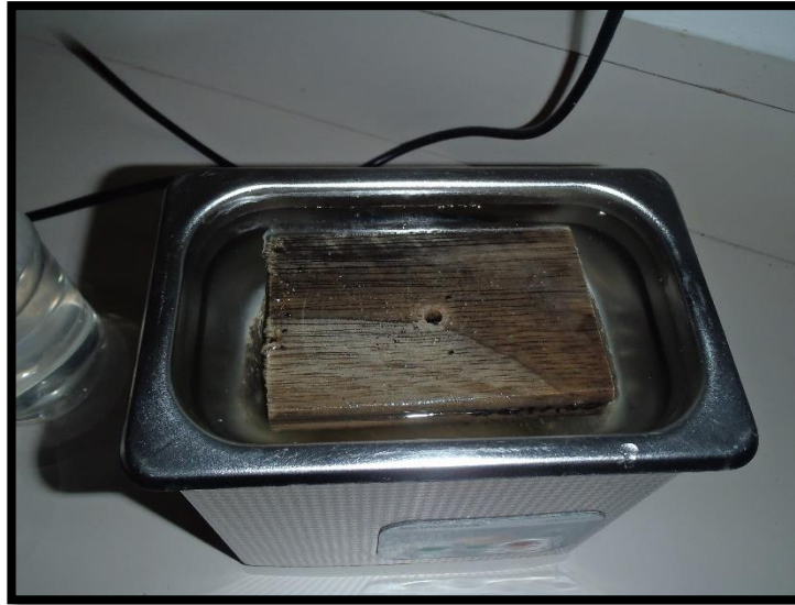
Figura 6. Foto de un cepillo en un baño ultrasónico. El ultrasonido duró de 3 a 5 minutos.
