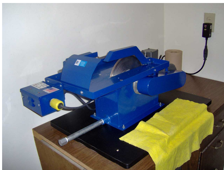
Figura 6. Proceso de corte de lajas de coral.
