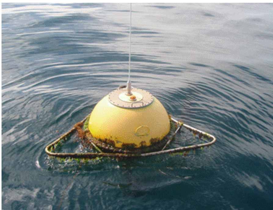
Figura 5.- Boya Waverider Mark III para mediciones de altura de olas (Imagen proporcionada por la empresa Energía Costa Azul)
