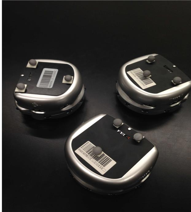
**Figura 69:** Marcas reflejantes colocadas en los robots para detección de posición.
