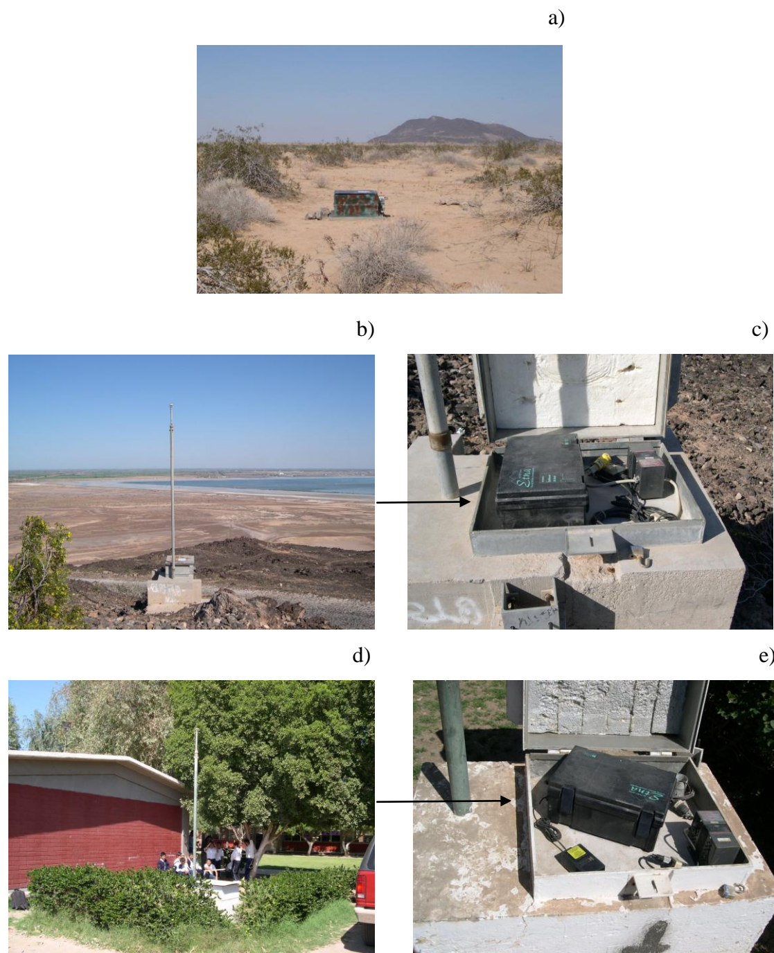
Figura 28. Estaciones acelerográficas: a) R02, b) VCP, c) instrumentación en VCP, d) DEL y e) instrumentación en DEL.
