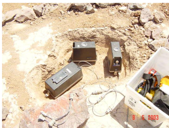
Figura 7. Instrumentación usada para el registro de datos de ruido sísmico. a) Grabadora SSR-1 (señalada con la flecha blanca) en la estación LMX (La Mesa de Andrade) y b) sismómetros de periodo intermedio en el sitio CRT.
