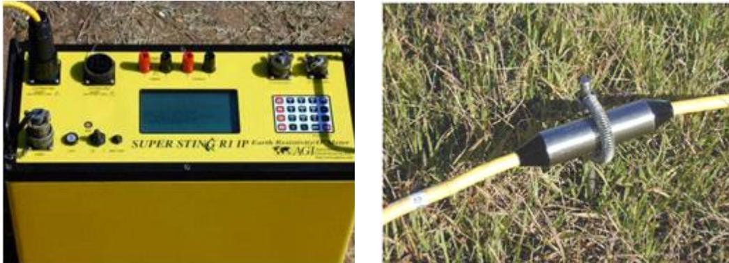
**Figura 12: Equipo Supersting R1IP de la empresa AGI empleado en el trabajo**
