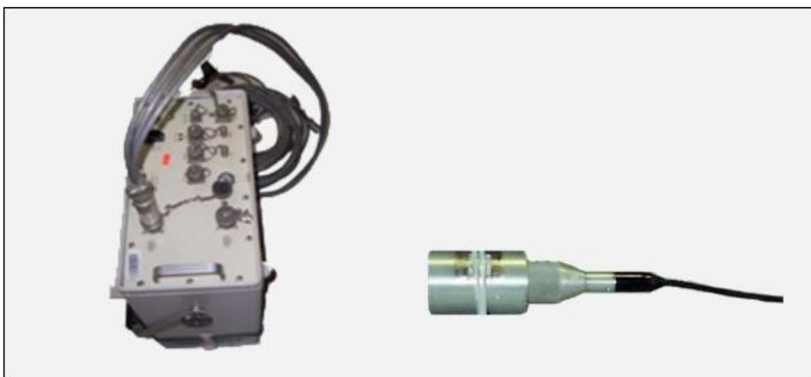
Figura 13. De izquierda a derecha: grabadora de datos SSR-1 y sensor de velocidades Mark L-4C.
