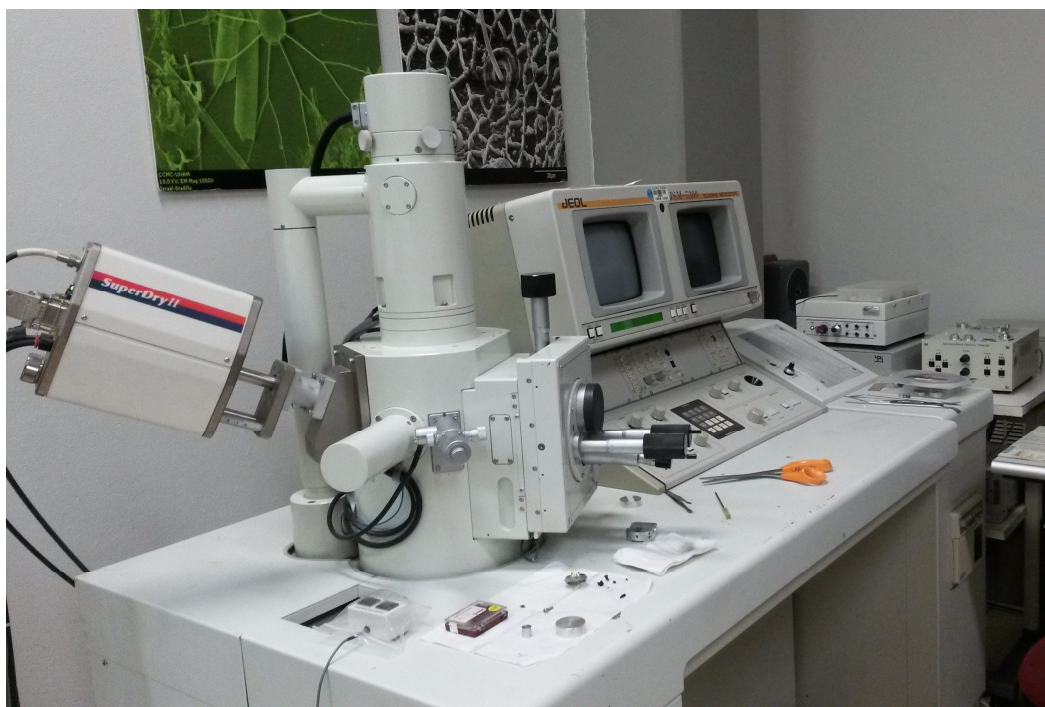
Figura 12. Microscopio SEM 1 JEOL JSM-5300 usado básicamente para los espectros adquiridos a baja temperatura (100K)
