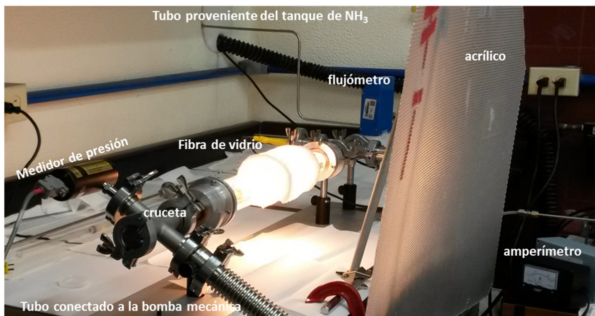
Figura 6. Sistema TE en operación durante la síntesis de nanoestructuras de GaN.
