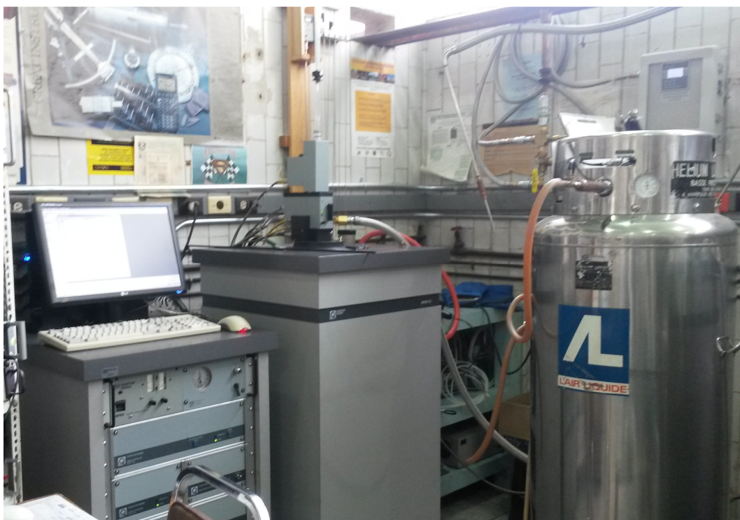
Figura 32. Magnetómetro SQUID MPMS-5S Quantum Design , en el IIM de la UNAM en CU.
