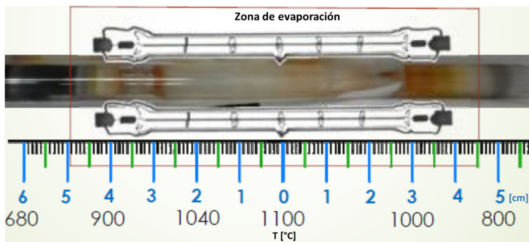
Figura 8. Imagen del tubo interno con las franjas de los depósitos obtenidos para cada compuesto.
