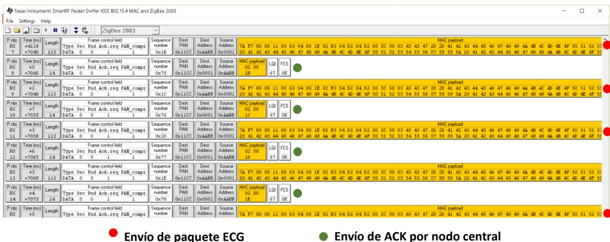
**Figura 53.** Captura sniffer 6LoWPAN de la transmisión de paquetes ECG, para una red 6LoWPAN con un nodo ECG.
