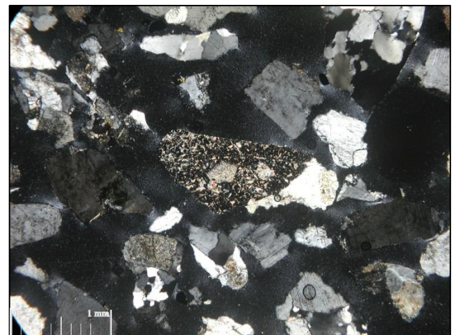
S18-4x. Arenas de la Playa El Sargento. Plagioclasas y feldespatos alterados. Al centro una plagioclasea con alto grado de sericitización, junto a un feldespato alterado a caolín y otros feldespatos con bajo grado de alteración.
