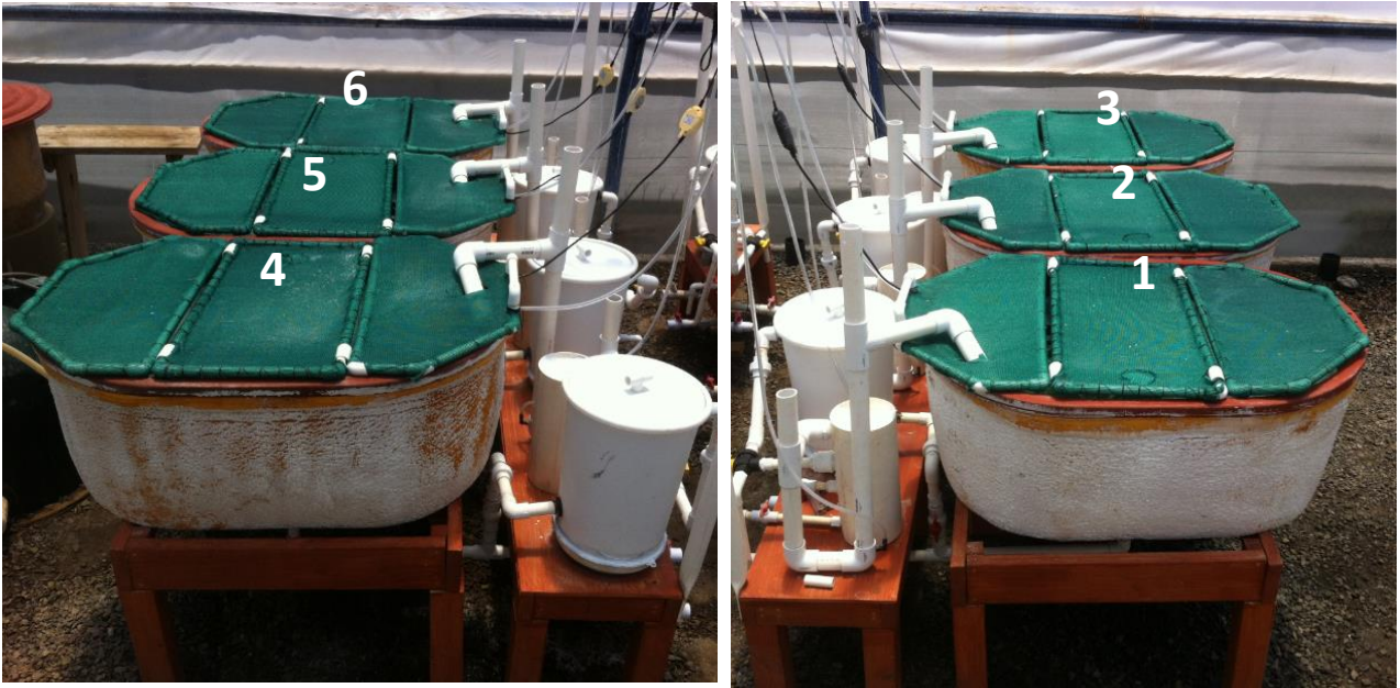
Figura 4. Disposición física de los tanques de cultivo para los tratamientos experimentales dentro del invernadero del IIO-UABC, en donde los SRA 1, 3 y 5 presentan un filtro de lavado continuo y los SRA 2, 4 y 6 tuvieron un filtro de lavado discontinuo.
