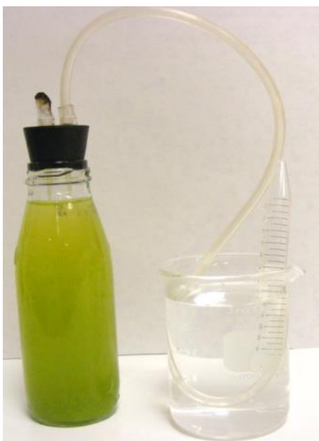
Figura 4. Biorreactor de vidrio cerrado herméticamente acoplado al dispositivo de medición de gas por desplazamiento de salmuera acidificada.
