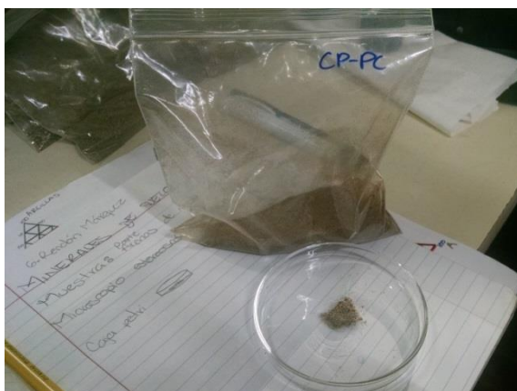
Figura 28.- Imágenes del procedimiento para la determinación del contenido mineral de la fracción de arena de las muestras de suelo.
