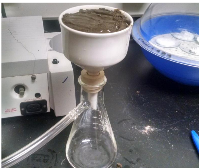
Figura 29.- Imagen del mecanismo de extracción al vacío del extracto de la pasta de saturación.
