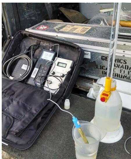
Figura 20.- Titulación potenciométrica in situ de alcalinidad de alícuota de agua de riego realizada en cada localidad. La bureta contiene HCl 0.1 N y el electrodo para pH conectado al potenciómetro dentro de la muestra.
