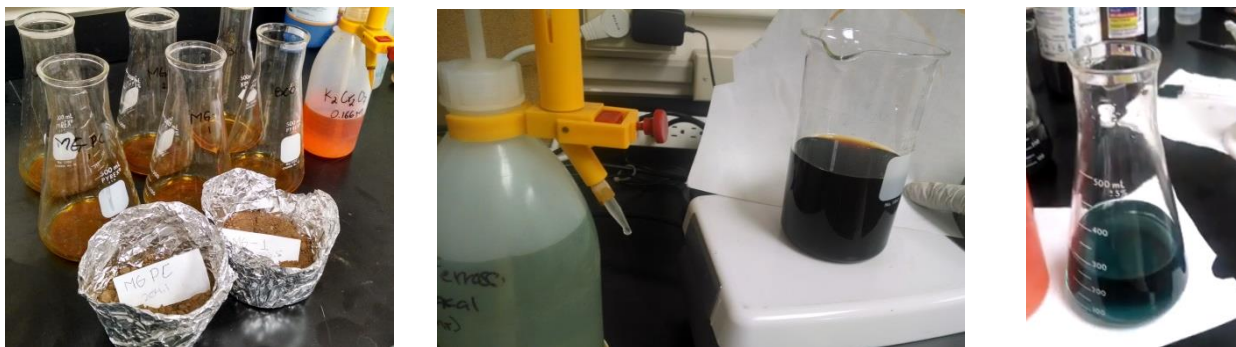
Figura 30.- Imágenes del método Walkley & Black para determinación de materia orgánica de las muestras de suelo.
