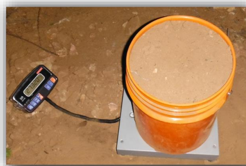
Figura 3. A la izquierda se lisímetro con sensor de pH y humedad, a la derecha la báscula portátil tomando la medida del peso.
