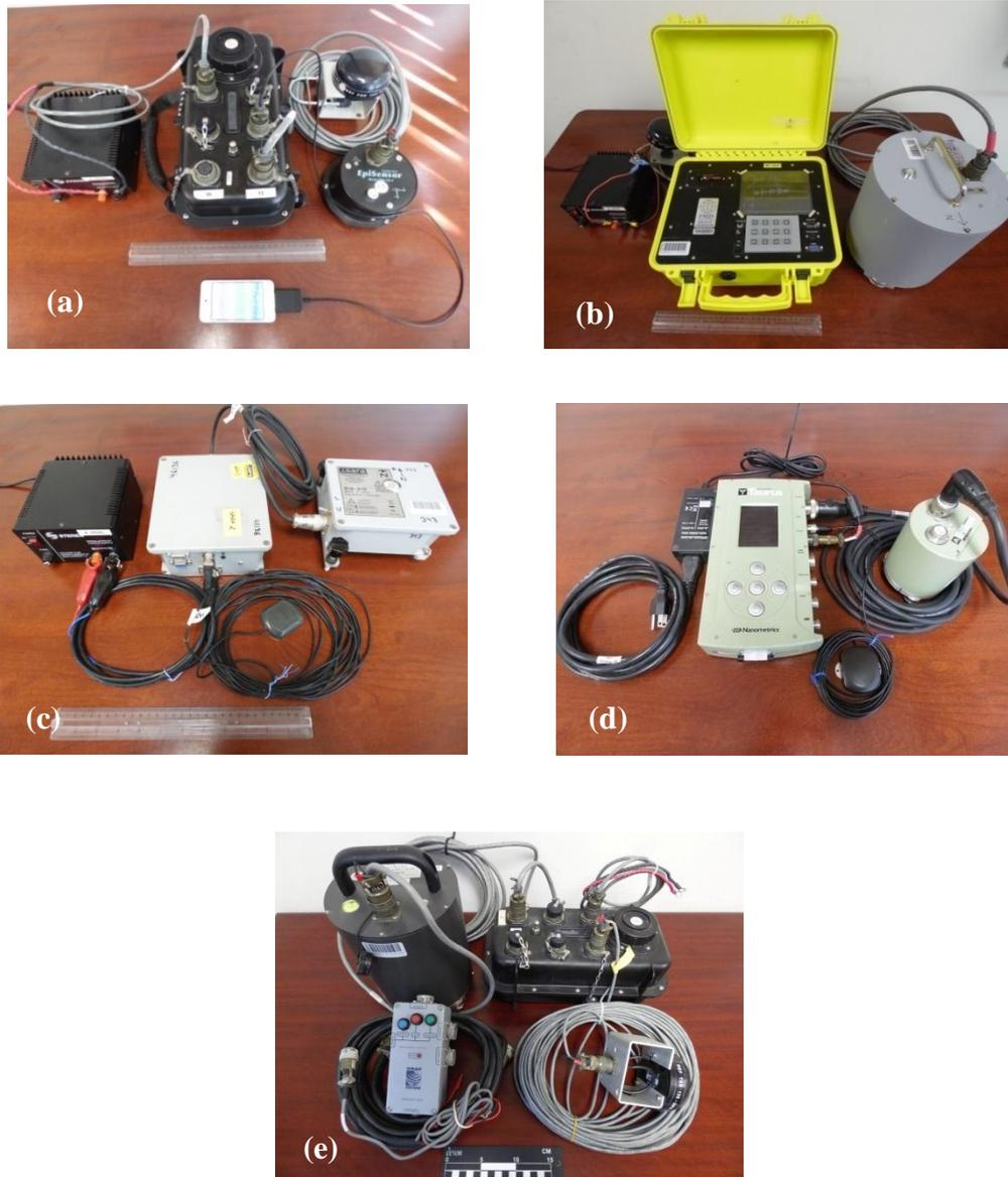
Figura 11. Instrumentación utilizada en las mediciones de vibración ambiental. a) Acelerómetro Episensor y Grabadora Reftek, b) Sismógrafo PMD, c) Sismógrafo Sara, d) Sismómetro Trillium Compact y Grabadora Taurus, d) Sismómetro Guralp, grabadora Reftek. Cada equipo se muestra con un dispositivo GPS y su fuente de poder.
