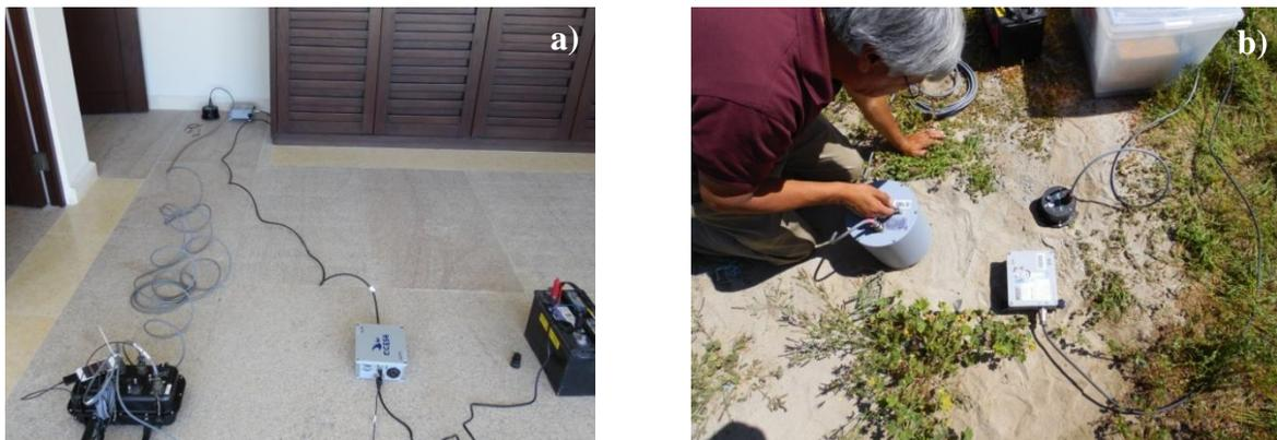
Figura 21. Colocación de sensores: a) en campo libre y b) dentro del edificio.
