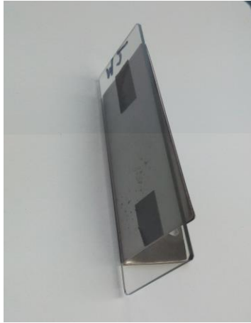
Figura 15. Portaobjetos con virus y base a 65° para realizar el depósito metálico de platino.
